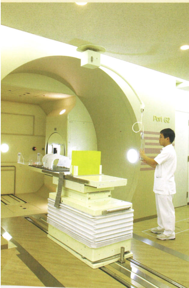
任意の方向から陽子線が照射できる回転ガンテリ。重量は110トン。シンクロトロンは直径30メートル。巨大な治療室と巨大な治療用具の出現だ
